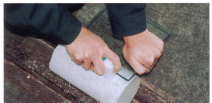
写真-2 円柱供試体での引っかけ試験
